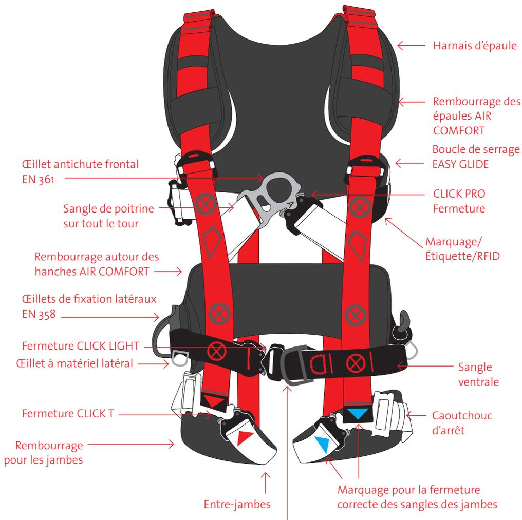
Cœillet multifonction/Cœillet de fixation
